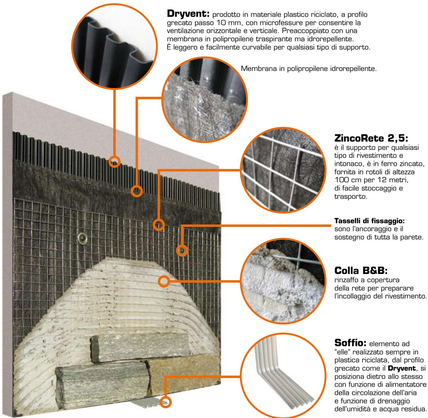
**Dryvent:** prodotto in materiale plastico riciclato, a profilo grecato passo 10 mm, con microfessure per consentire la ventilazione orizzontale e verticale. Preaccoppiato con una membrana in polipropilene traspirante ma idrorepellente. È leggero e facilmente curvabile per qualsiasi tipo di supporto.
